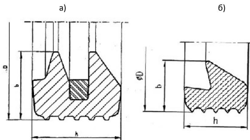
Рисунок 3 - а) Уплотнительного кольца двухлепесткового типа;
