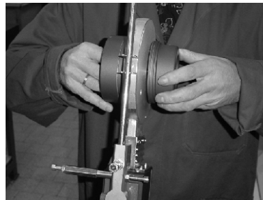
Рис В. Установка насадок на нагревательном элементе.
