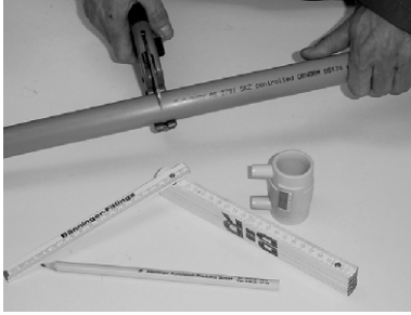
1. Отрезать трубу под прямым углом с помощью ножниц или трубореза.
