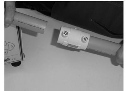
6. Надвинуть муфту на трубу до отметки.
