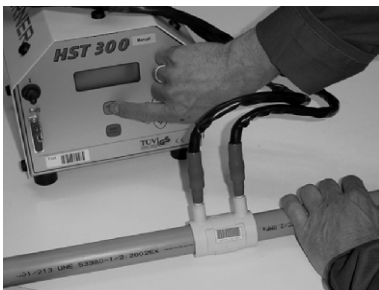
7. Штекеры кабеля вставить в контактные гнезда. Установить на сварочном аппарате напряжение (V) и время сварки. Все параметры указаны на штриховом коде на наклейке муфты. Начать сварочный процесс, нажав на включатель.
