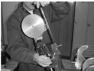
Рис А. Установка нагревательного элемента в крепление.
