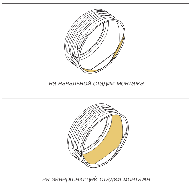
Рис. 2.6 Место контакта резинового уплотнителя и внутренней поверхности раструба
