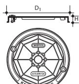
■ устанавливается непосредственно на гофрированную трубу
