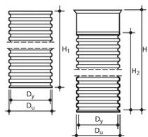
■ шахтная труба канализационного колодца без уплотнительного кольца
