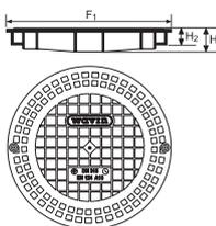
■ устанавливается непосредственно на гофрированную трубу
