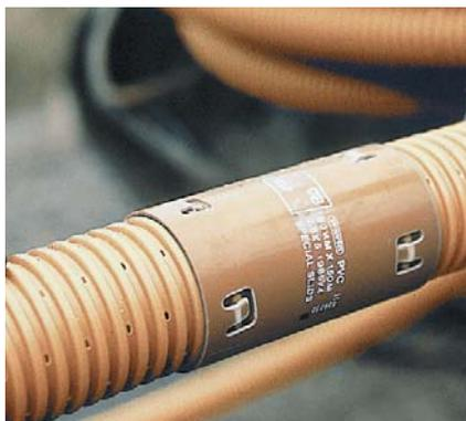
Конец трубы без муфты задвиньте в муфту как можно глубже и проверьте прочность соединения труб (защелки муфты должны прочно зафиксироваться на гофрах труб).
